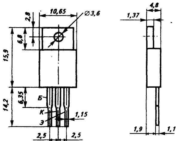
Транзистор кремниевый меза-планарный структуры  $n-p-n$  переключательный. Предназначен для применения в высоковольтных переключательных схемах, усилителях постоянного тока. Выпускается в пластмассовом корпусе с жесткими выводами. Масса транзистора не более 3 г.
